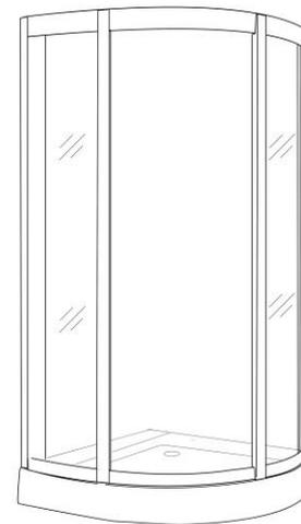
5. Соедините переднее стекла с задними стенками саморезами М4 \* 10. Установите среднюю панель на заднюю стенку.
