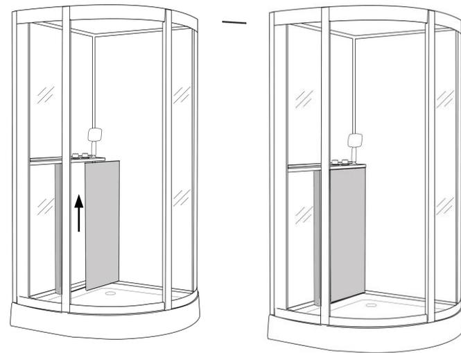
6. Затем закрепите вертикальную панель саморезом М4\*10. установите небольшую планку на поддон саморезом М4\*10
